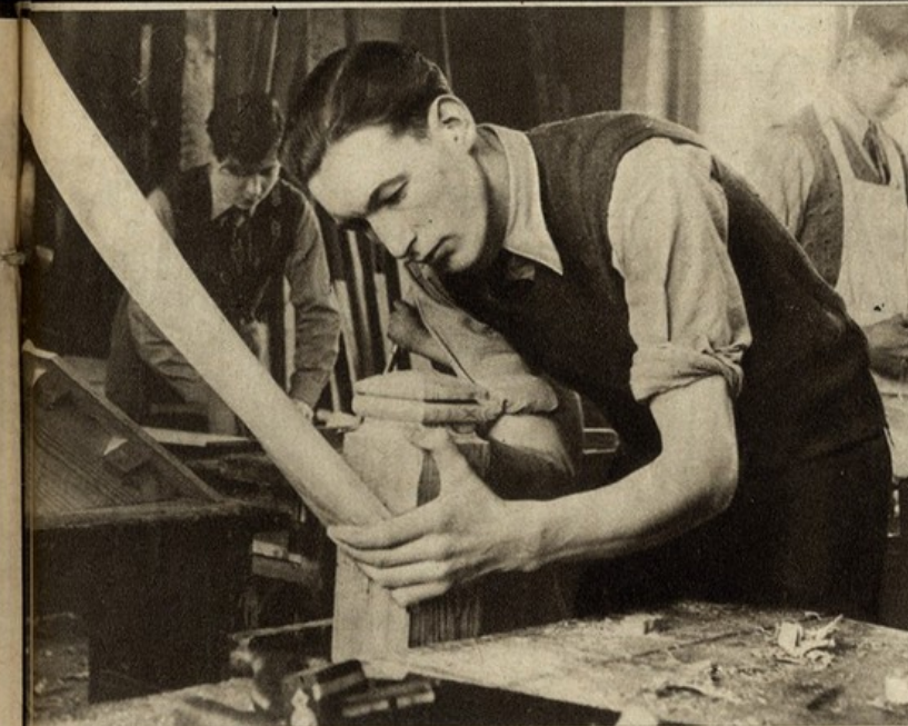
Um aluno de 19 anos coloca, em posição, o corrimão de uma escada de sua própria construção
