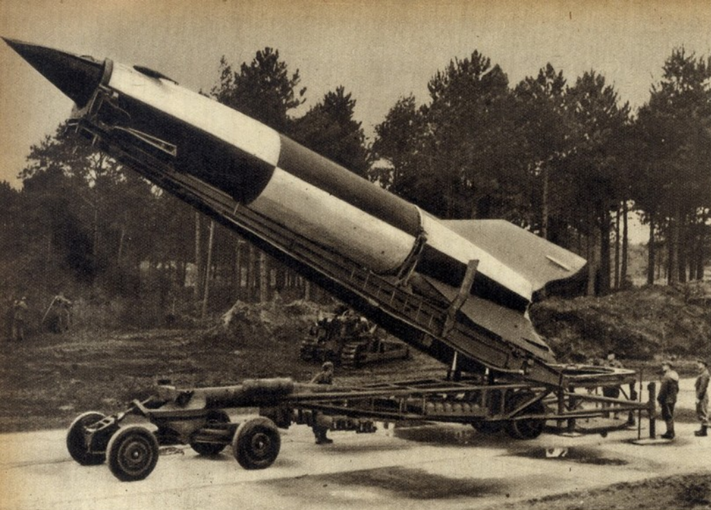
A bomba voadora, no seu suporte metálico, tal qual eram utilizadas pelos alemães nos seus bombardeamentos indiscriminados da Inglaterra. O suporte pode tomar o ângulo que se deseje, de harmonia com a trajectória que se pretende fazer percorrer pelo projectil
