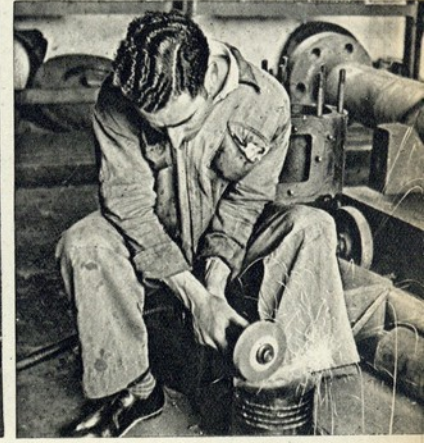
A roda de esmeril, a 500 rotações por minuto, abre um sulco num êmbolo
