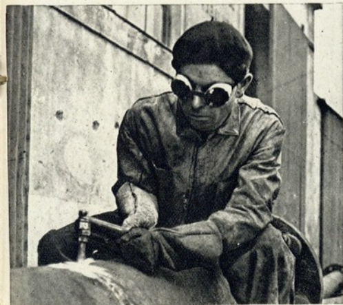
O maçarico oxí-acetilénico corta um grosso tubo de ferro
