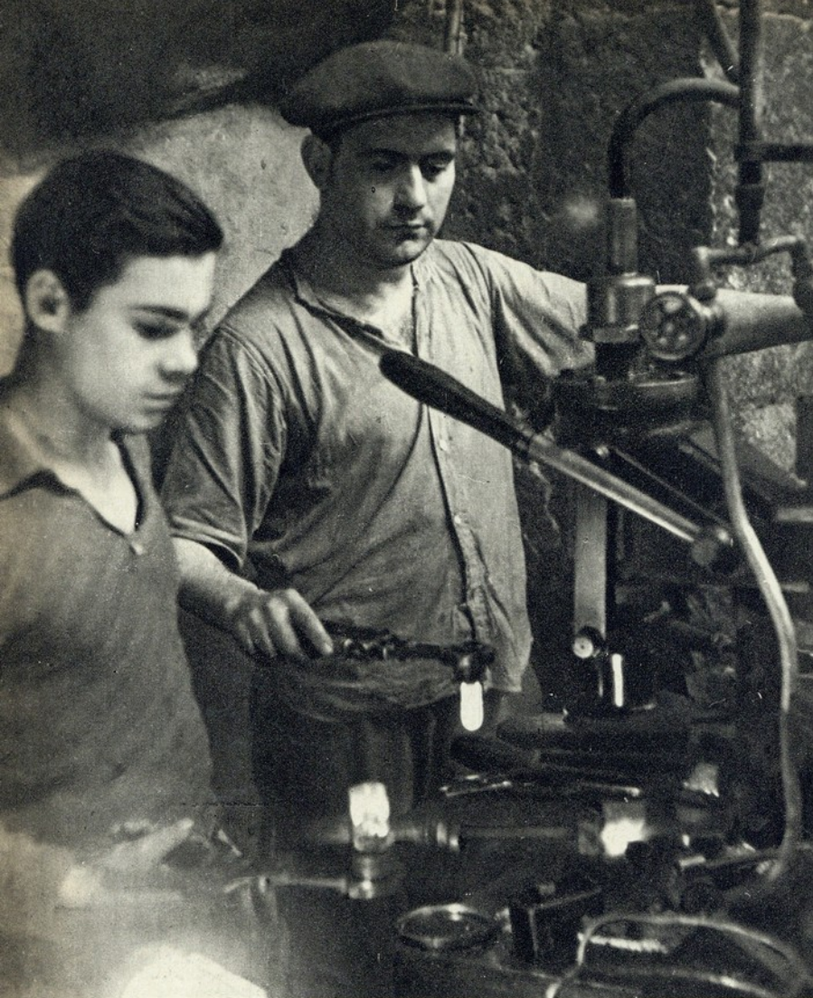
Como se faz um frasco. A massa vitrea, que fundiu a 2000 graus, vai ser mollada mecânicamente
