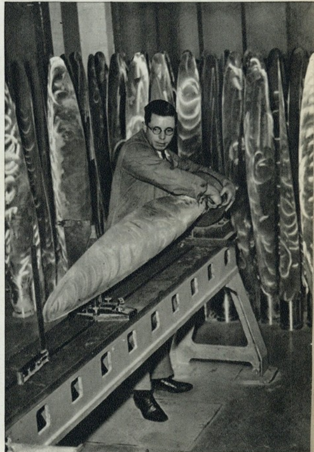
A produção aeronáutica inglesa atingiu números nunca igualados. Numa fábrica, um operário procede ao acabamento duma hélice
