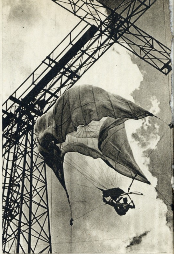
O paraquedas desdobra-se lentamente, com as suas extremidades deslizando ao longo de espigas de aço
