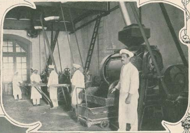
1—A experiencia de uma nova marca de bolacha 2—As amassadeiras mechanicas 3—O laminador
