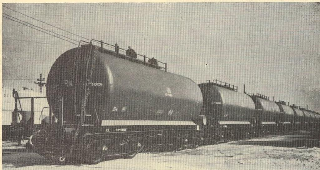
Comboio de vagões cisternas de 50000 litros de capacidade para o transporte de fuel-oil, com calefação para a sua descarga, construídos para a Rede Nacional dos Caminhos de Ferro Espanhóis
