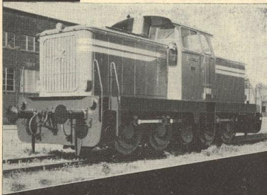
Em todas as combinações de rodados e eixos-motores, desde os mais simples de 2 eixos-motores, até às mais potentes máquinas com 2 bogies de 2 eixos ou de 3 eixos cada (B-B ou C-C).
