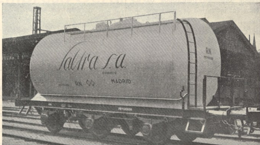
Yagón cisterna de grand capacidad (450 Hls), com bastider aligerade, montado sobre tres ejes unificados tipo RN-20 y cajas de engrase ISOTHERMOS, con freno de husillo y vacío (dos cilindros) y equipo completo SAE, Construcción 1937.
