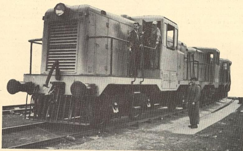
Tractores de manobra Diesel Eléctricos de 45 ton., General Electric,
