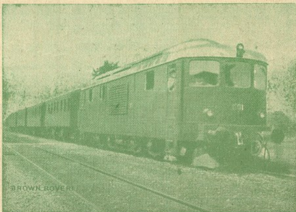
A primeira locomotiva do mundo com turbina a gaz (2.200 CV.)
