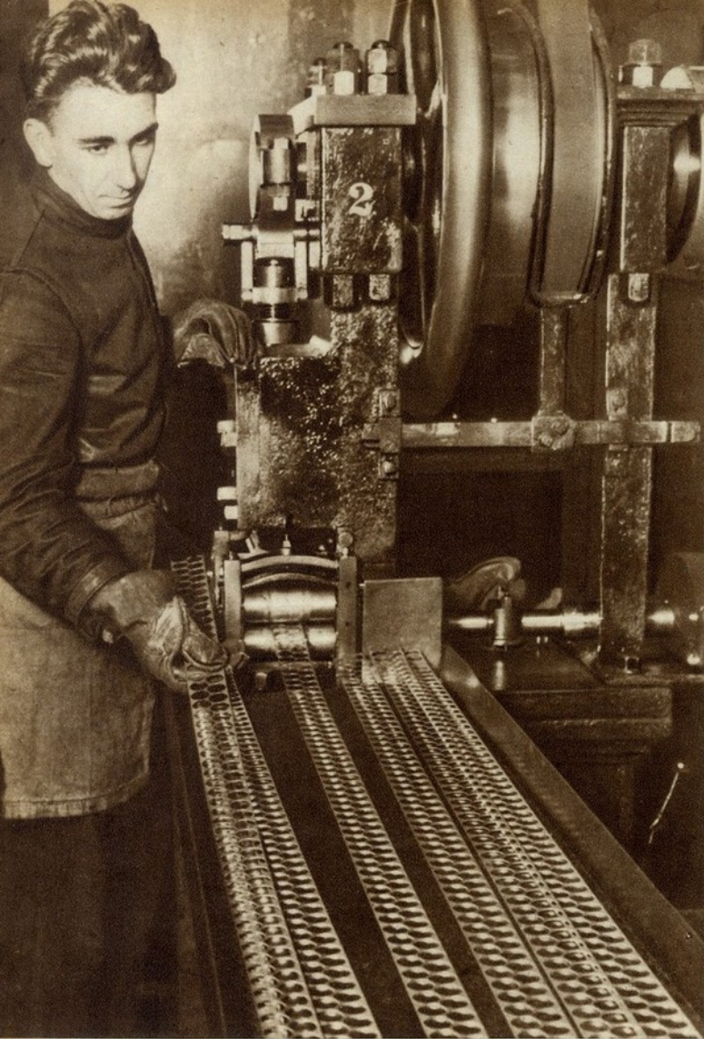
Desias tiras metálicas cheias de orifícios cilíndricos, saíram as moedas antes de cunhadas
