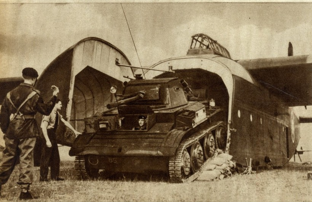
Os gigantescos planadores britânicos Hamilcars são construídos para transportar tanques «Tetrarcas» e outros carros blindados demasiado volumosos para entrarem nos aviões rebocadores. Em Arnhem, os Hamilcars, 15 segundos depois de aterrarem, despejavam veículos, que já tinham os motores em marcha, enquanto os planadores ainda estavam no ar
