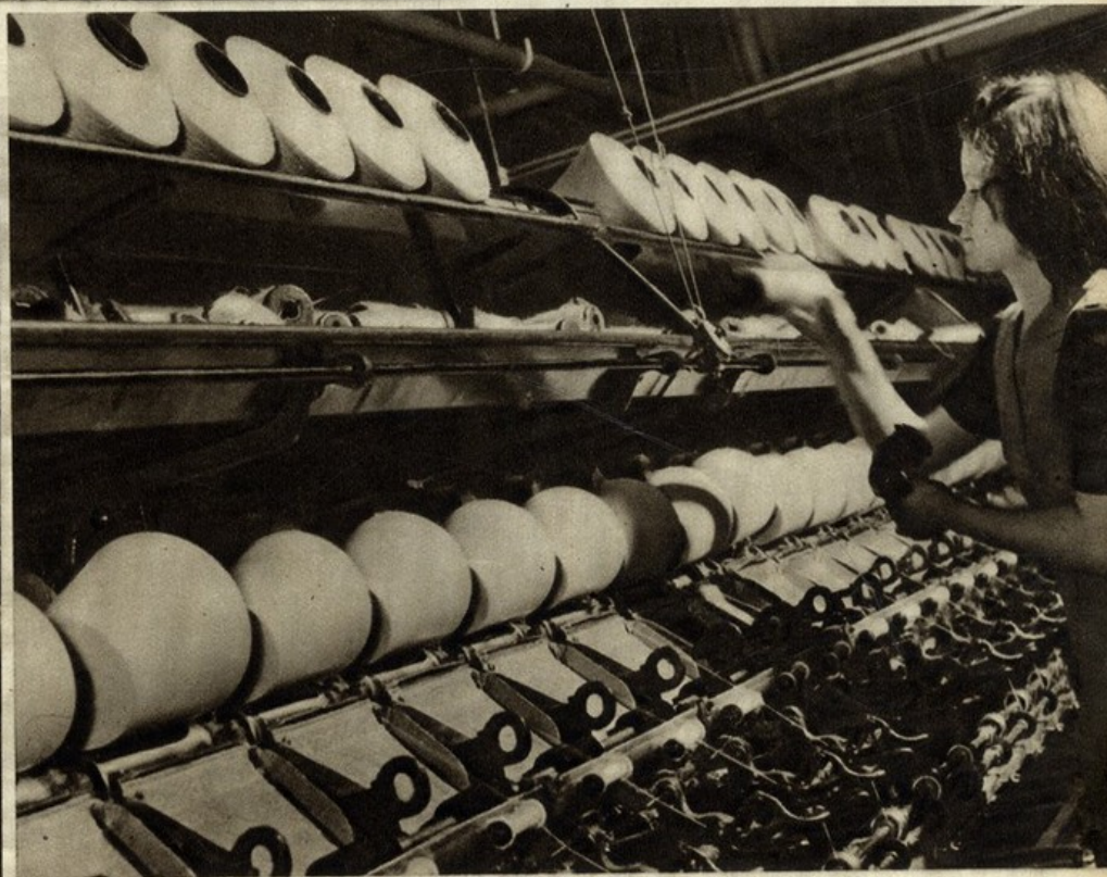
Esta enroladora «produz» bobinas cónicas de fios
