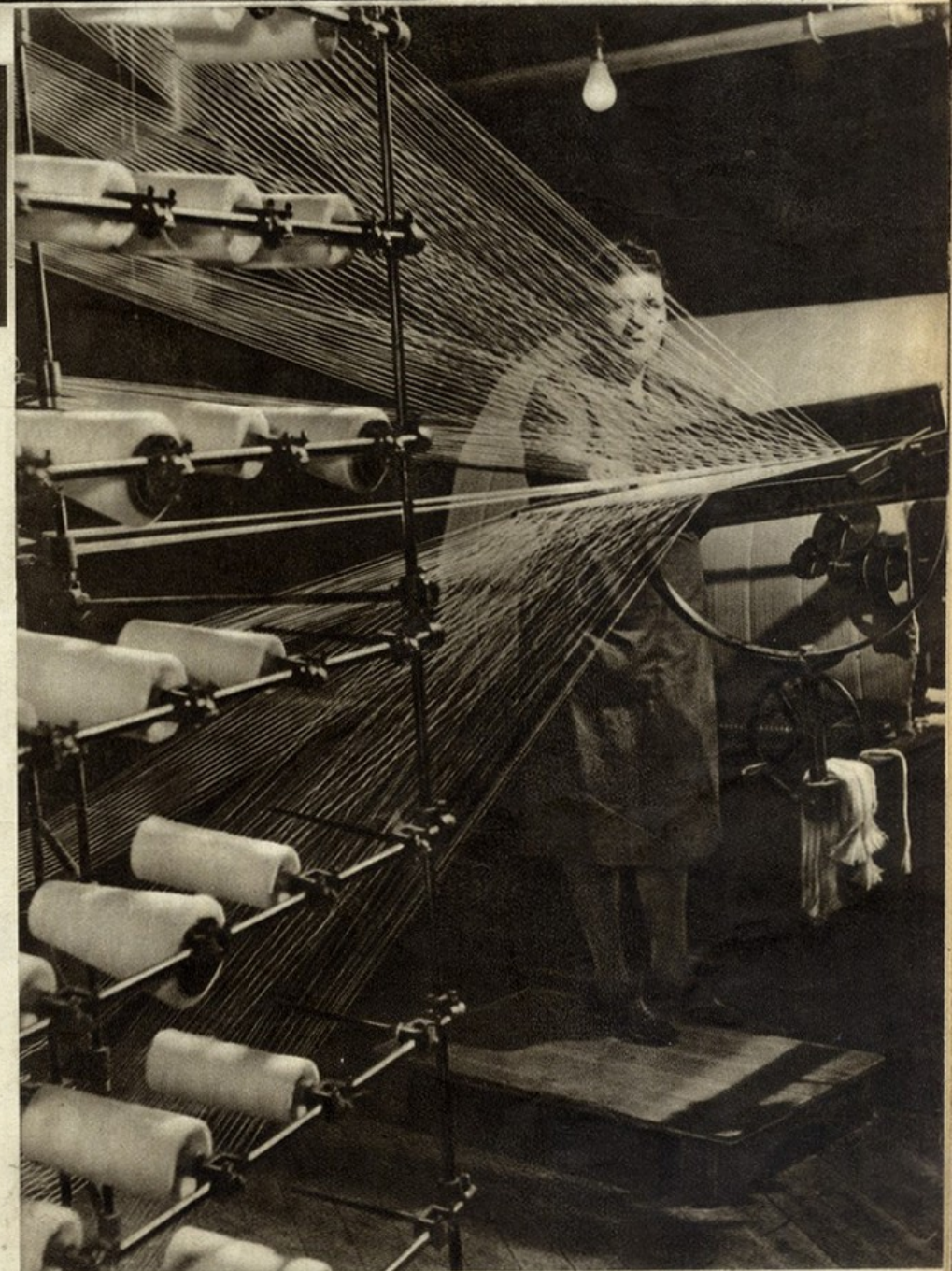
Um sistema de enrolamento mecânico, que a operária dirige, intervindo, apenas, quando a linha, o que é raro, se quebra
