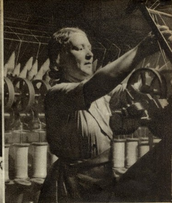
Uma máquina de emolar. Cada fuzo converte-se num carrinho de linha
