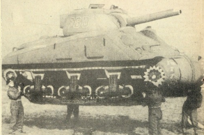
Este é o modelo do tanque «Sherman» de borracha, que pesa apenas 77 quilos. Depois de esvaziado do ar pode meter-se numa malaça pouco maior do que um jogo de golfe.
