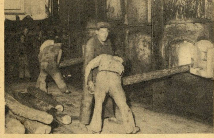
As caldeiras de alta-pressão precisam, diariamente, de toneladas de combustíveis! Os operários, no meio dum grande calor, enchem de lenha a bocarra insaciável da fornalha!
