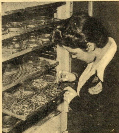
À luz do dia, as sementes são experimentadas num quarto munido de vidraça para deixar entrar a iluminação necessária à germinação de algumas sementes. Vemos aqui um tecnologista que conta o número de sementes duma espécie de grama que, num mata-borrão molhado, rebentou em pratos de vidro, pendurados no germinador por cinco dias.
