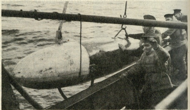
3 — Agora, cada barco vai munido de um «Oro pesa», que é um flutuador em forma de torpedo, ligado ao caça-minas por um cabo-serra. Com o andamento, os «oropesas» conservam-se numa trajetória paralela com o barco, esticando o cabo que, assim, apanha as minas que encontrar, cortando-lhes o cabo de amarração.
