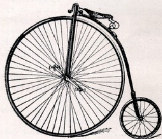
O BICYCLO, antecessor da bicyclêta
