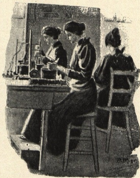
Soldando os filamentos em pontas de platina.
