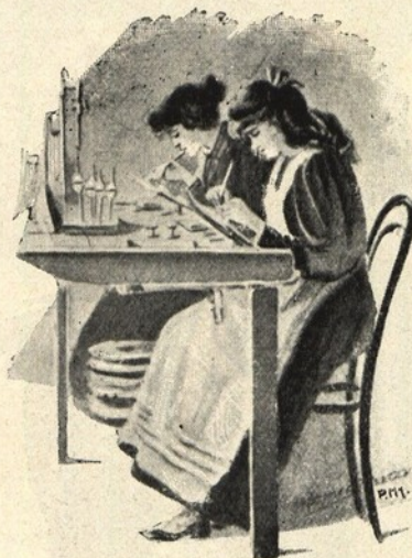
Inserindo os filamentos compostos dentro do globo
