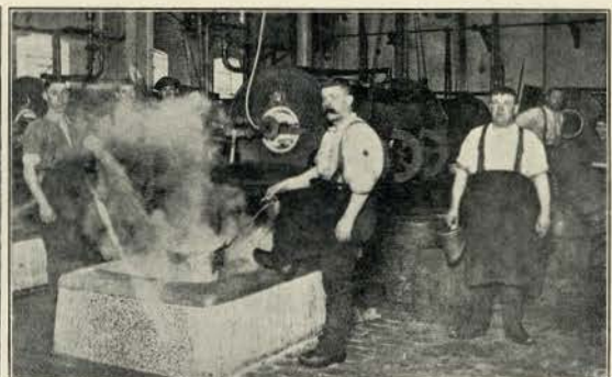
Fundindo o metal para as capsulas de cartuchos 303.
