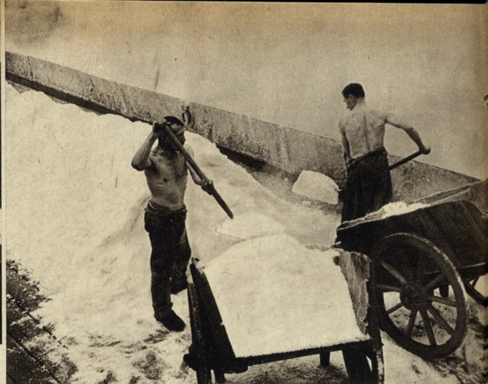
O processo de evaporação, em tinas ao ar livre, onde se produz o sal comum, grosso, para uso comercial — salga de peixe, etc.
