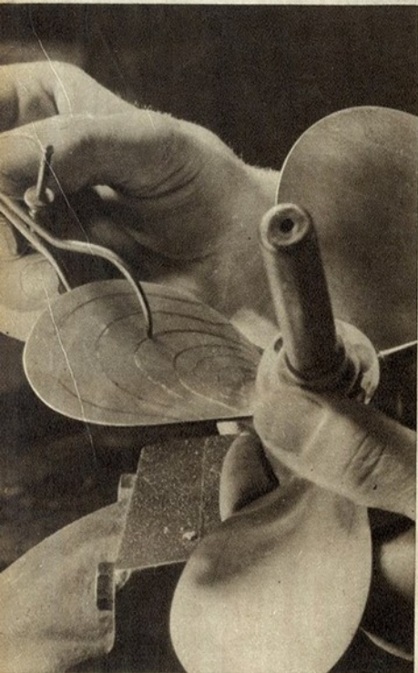
O modelo da hélice é fundido e feito de uma liga metálica conveniente. Verifica-se aqui a espessura das pás
