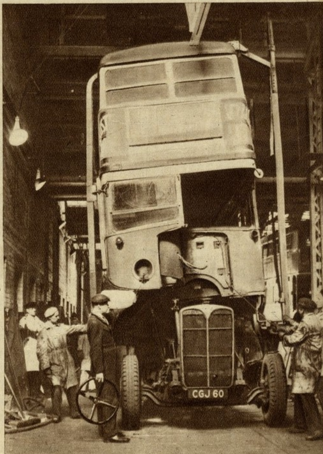
O carro é completamente desmontado. Primeiro, retira-se a super-estrutura de cima do chassis e coloca-se sobre uma vagoheta baixa para ser facilmente removida para outra secção
