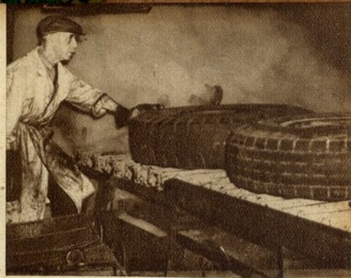
As rodas e outros acessórios pequenos passam por outra máquina de lavar, onde jactos de vapor removem toda a sujeira
