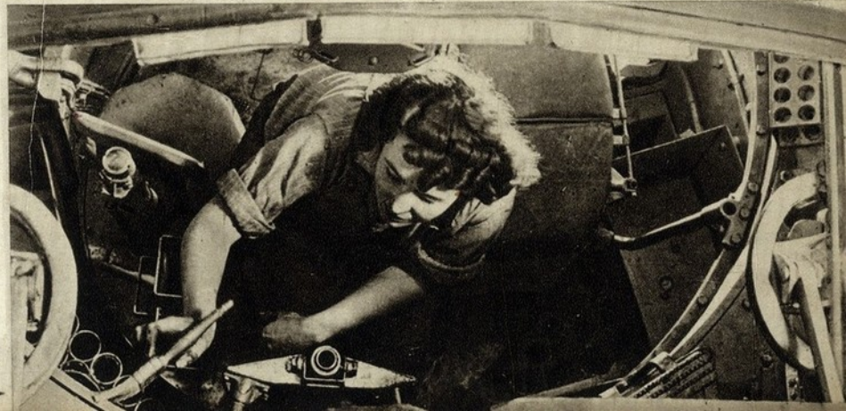
As máquinas fazem tudo, desde as peças mais simples às mais complicadas. Este operário está a abrir os furos para a rebiteagem deste acessório cilíndrico
