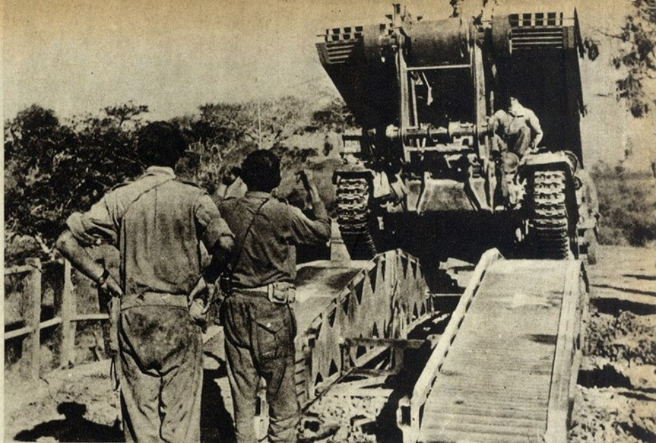
Um tank «Churchill» com a ponte tesoura, atravessa, facilmente, uma vala aberta no caminho por uma granada
