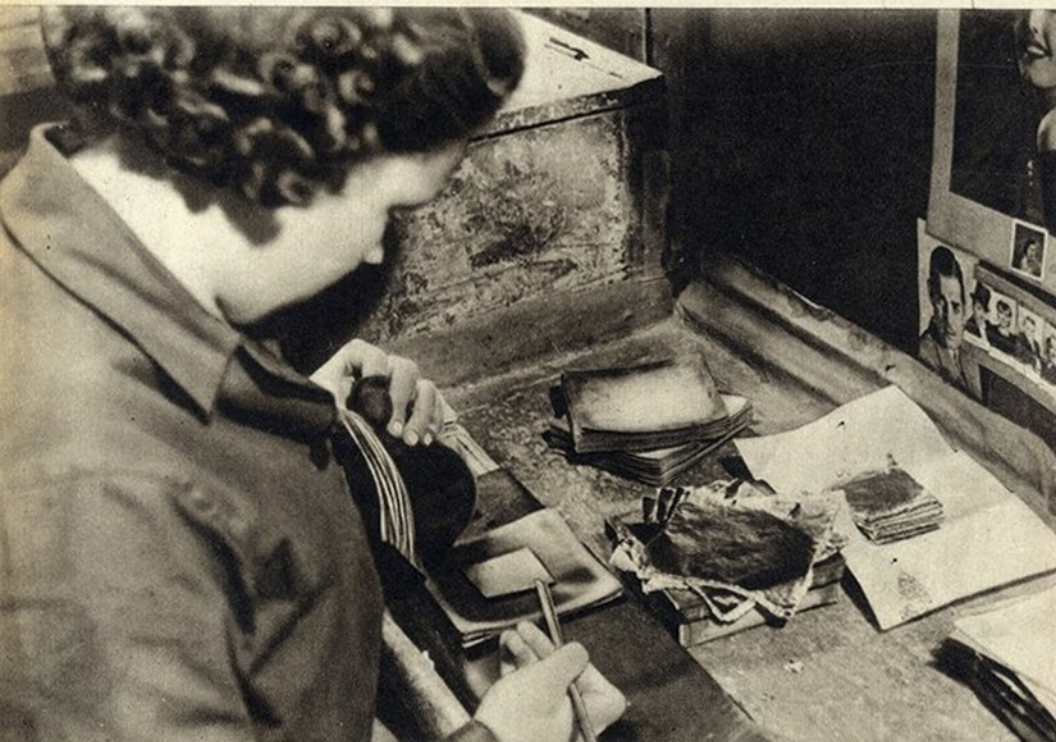
Depois da primeira operação, as lâminas são colocadas entre as folhas do «livro de pele» para tornarem a ser marteladas
