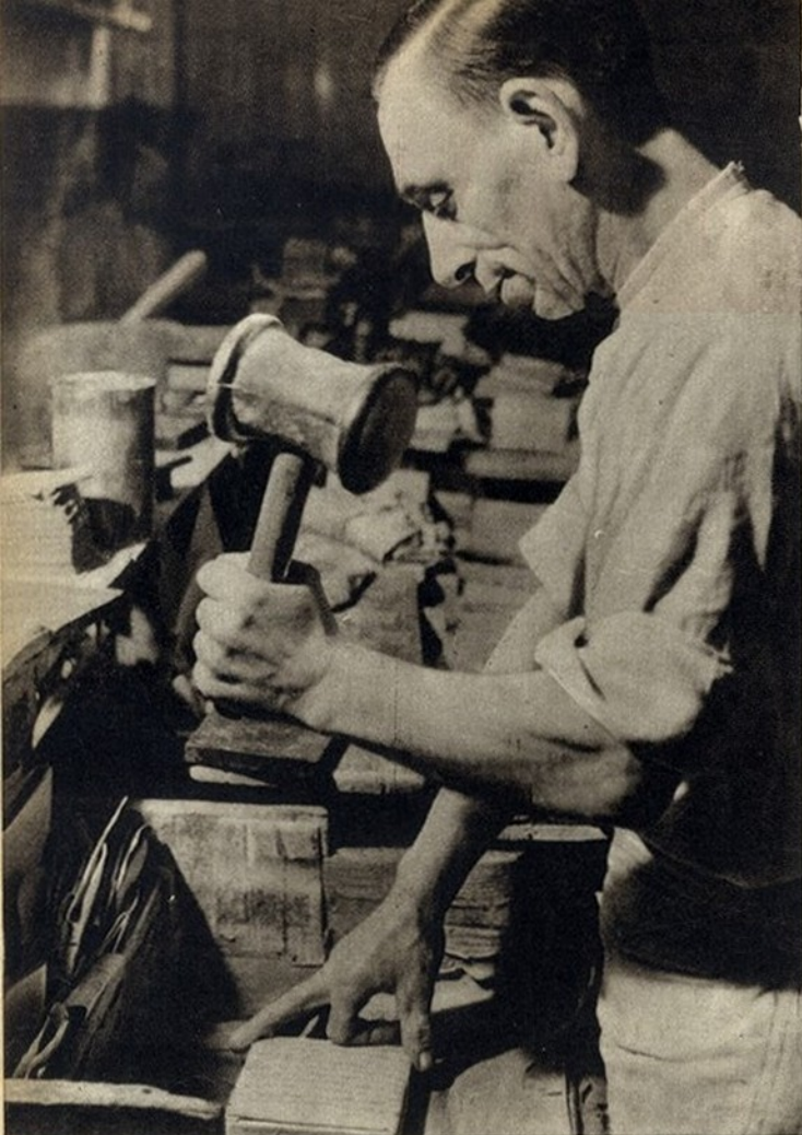
Os operários batem durante horas, em ritmo elástico, como sem esforço. A lâmina de ouro, entre duas folhas de pergaminho, assenta sobre mármore
