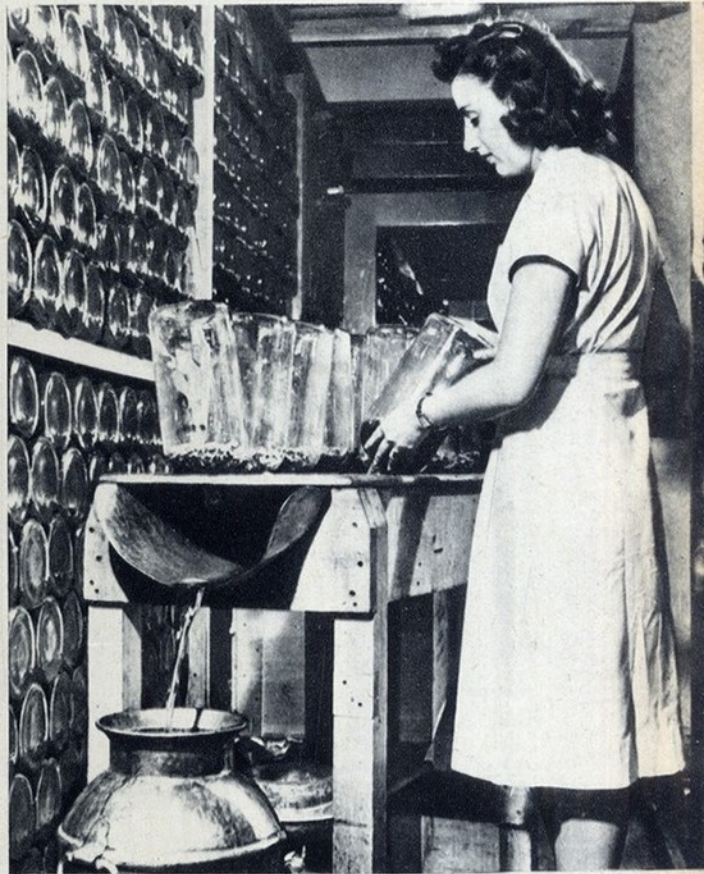
A preparação do famoso medicamento é lenta e laboriosa. Uma preparadora de um laboratório norte-americano despejando o líquido que juntou à cultura do bolor
