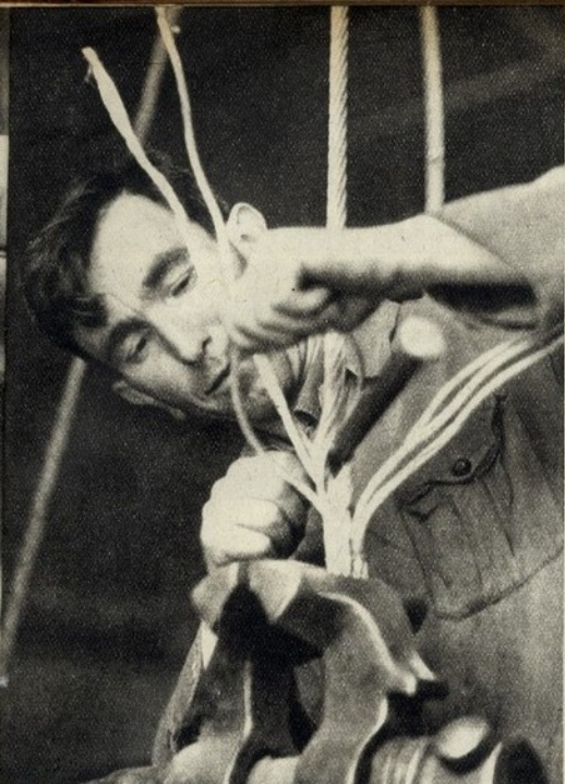
Este cabo de aço quebrou-se. A tarefa delicada de o reconstruir
