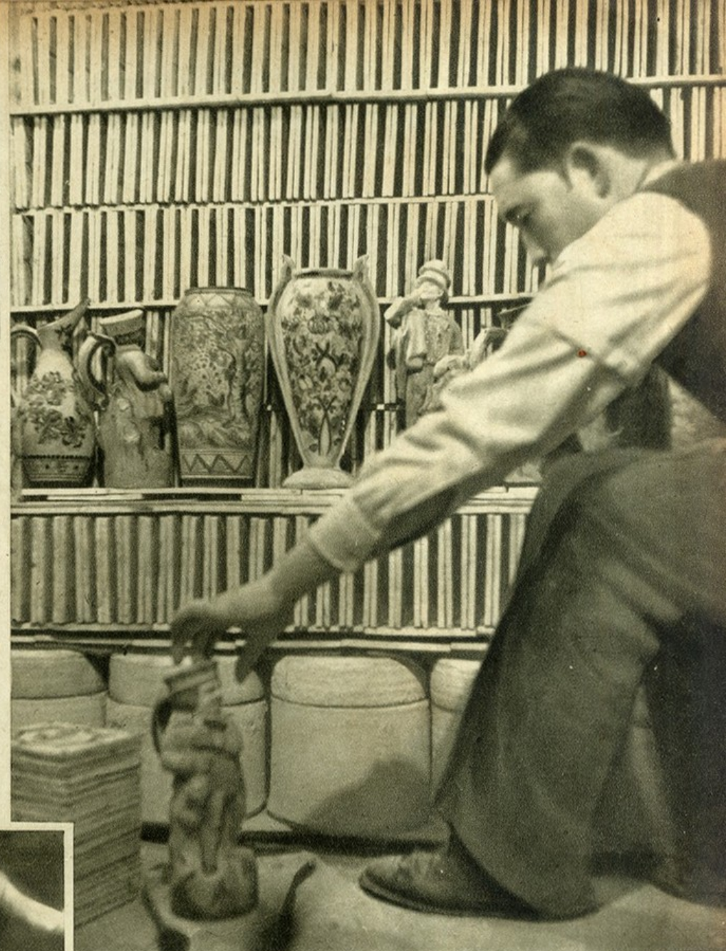
No forno, os azulejos, dispostos paralelamente em sucessivas prateleiras, parecem lombadas de livros numa biblioteca
