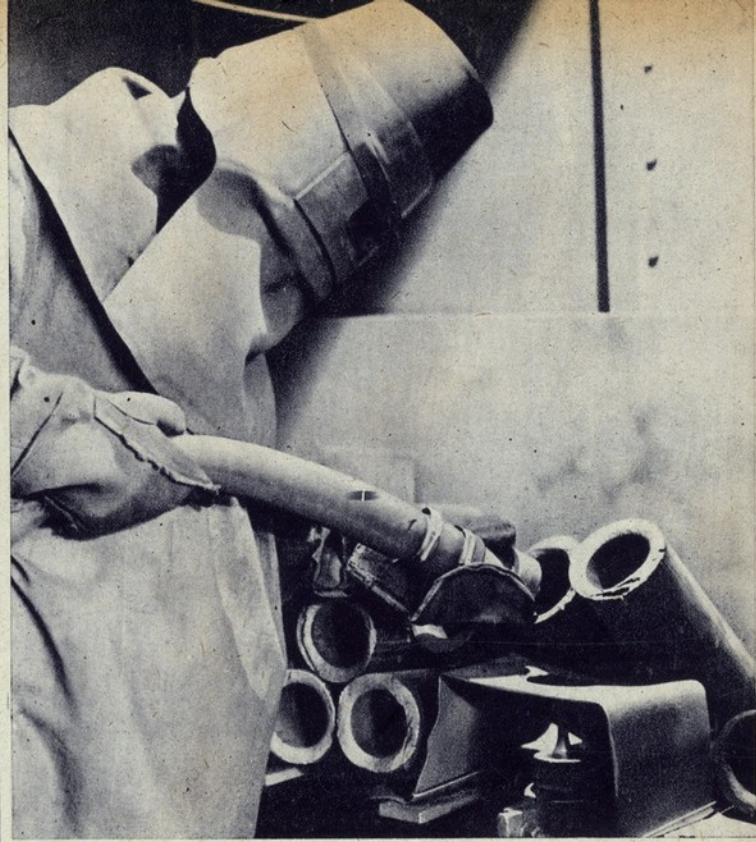
O homem que trabalha com o oxigênio nas grandes indústrias precisa destes equipamentos especiais, muito semelhantes aos escafandros dos mergulhadores, para evitar quaisquer acidentes.
