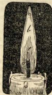
Fig. 7—Estrutura da chamma
