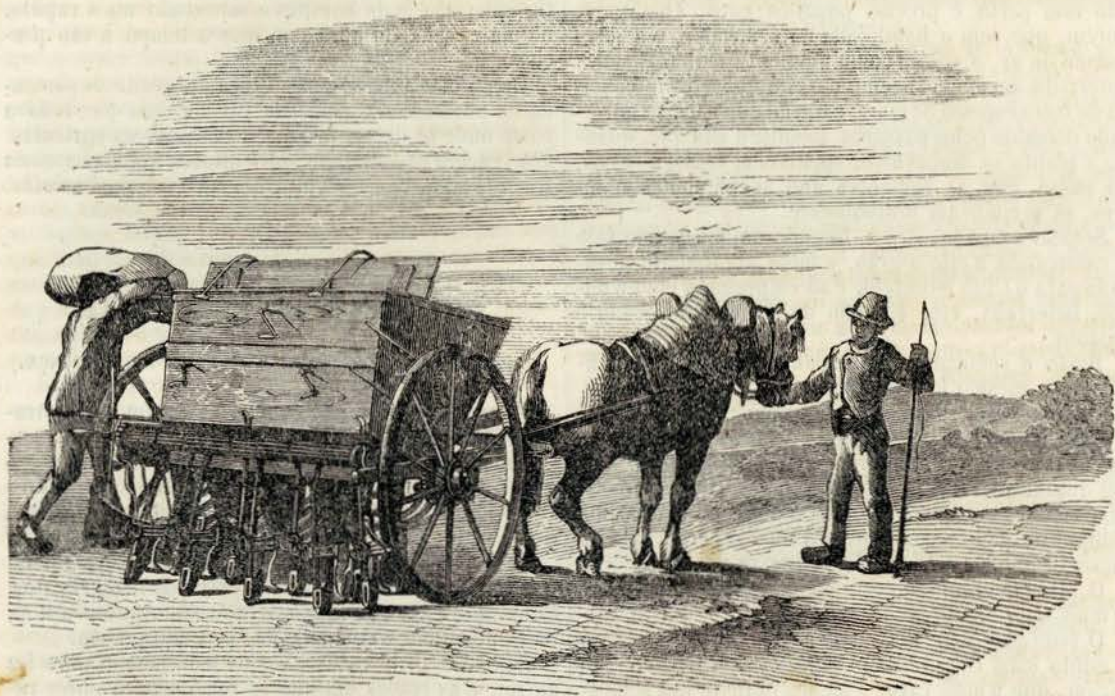
Semeador mechanico de Hornsby. — Gravura de Coelho.
