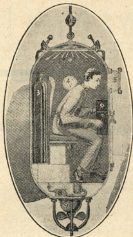
● ultimo sino de mergulhador de Hartman: 1, electro-magneto formado por duas conchas de ferro; 2, ganchos; 3, cilindro de oxigenio; 4, «manometro» de profundidade; 5, oculo; 6, camara de filmar e oculo; 7; 8, purificador do ar; 9, motor da helice.
