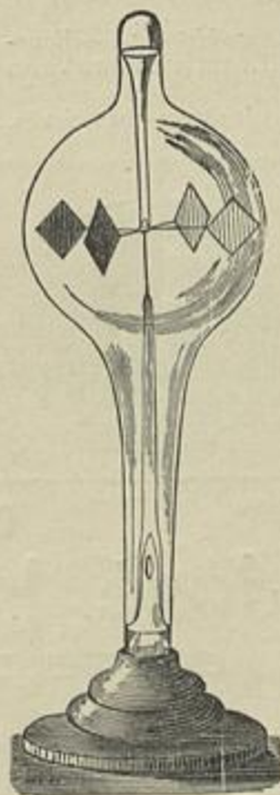
FIG. 64 RADIOMETRO DE CROOKES
