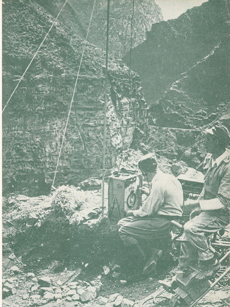
Uma das estações portáteis de 15 vátiols colocada nas Cordilheiras do Perú a 4.000 metros de altura. A energia é conseguida por um gerador de pedal
