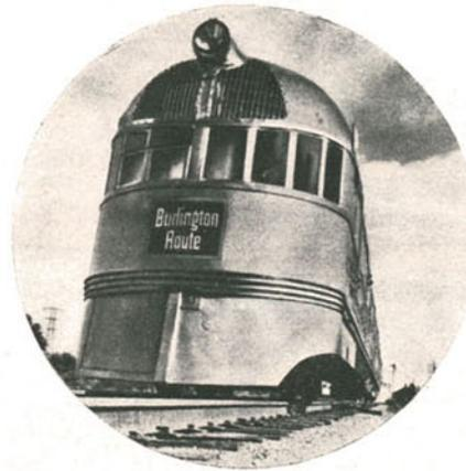
Uma das automotoras mais rápidas da America do Norte. É accionada por um motor Diesel e coberta por uma carapaça de aço inoxidável
