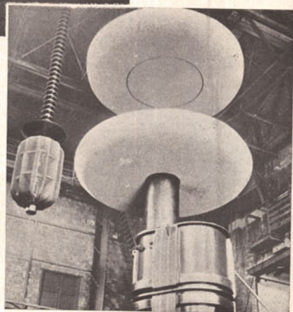
Em cima: Curioso aspecto duma descarga de 200.000 volts. À direita: O condensador empregado na medição das altas voltagens
