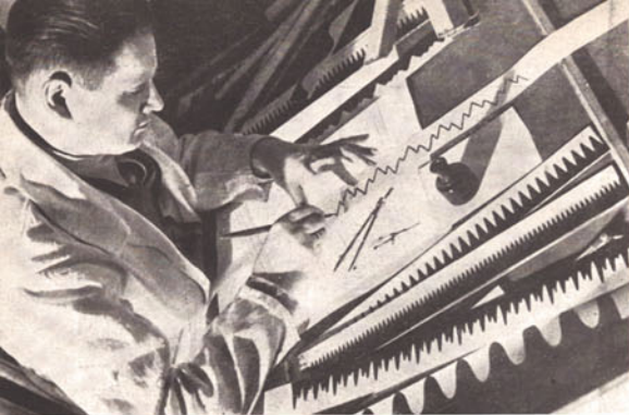
Rudolf Pfenninger desenhando, no seu estúdio da «Emilika» o contorno duma vibração sonora. Em baixo, o preenchimento do desenho com tinta da China
