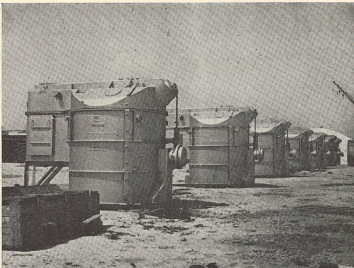
Auto-transformadores de 220/150 kv. destinados à subestação de PEREIROs da C. N. E. depois do desembarque no porto de Lisboa
