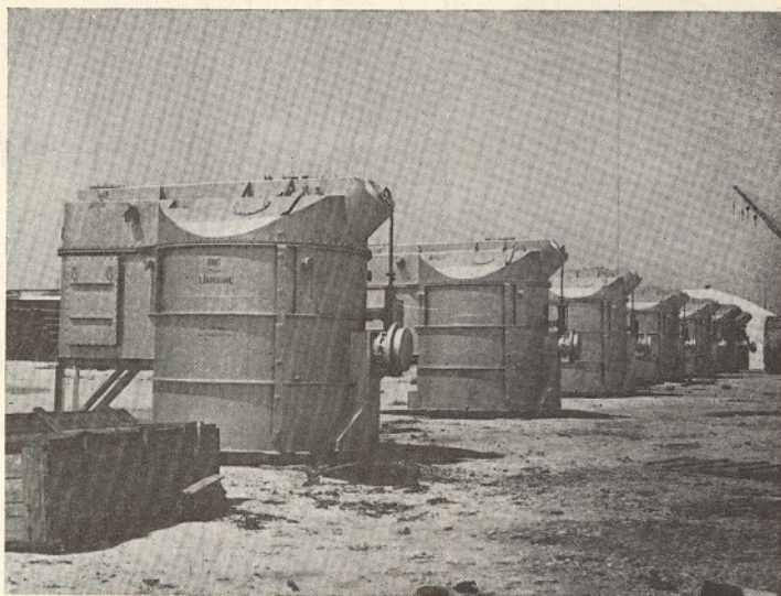
Auto-transformadores de 220.150 kv. destinados à subestação de PEREIROSA da C. N. E. depois do desembarque no Porto de Lisboa
