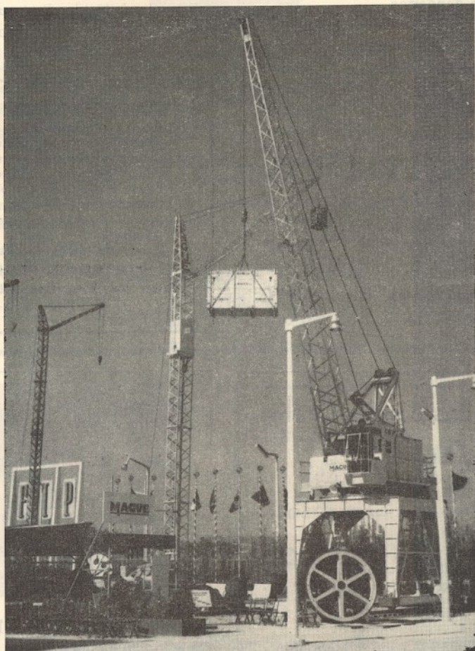
Guindastes portuários Diesel de 3 ton. a 14 m., destinados à ponte cais de Noqui em ANGOLA Aspecto de uma das unidades construídas, em exposição no stand da MAGUE na F. I. P. de 1957
