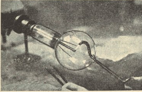
Procedendo à extracção dos suportes deteriorados do filamento da lâmpada
