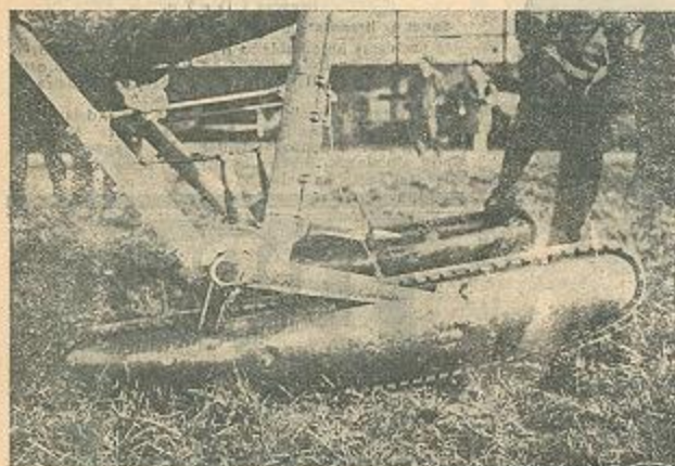
Em vez das rodas clássicas para a aterragem, um inventor propõe o uso de lagartas, como os tractores, o que parece trazer um considerável acréscimo de segurança e de estabilidade aos aparelhos.
