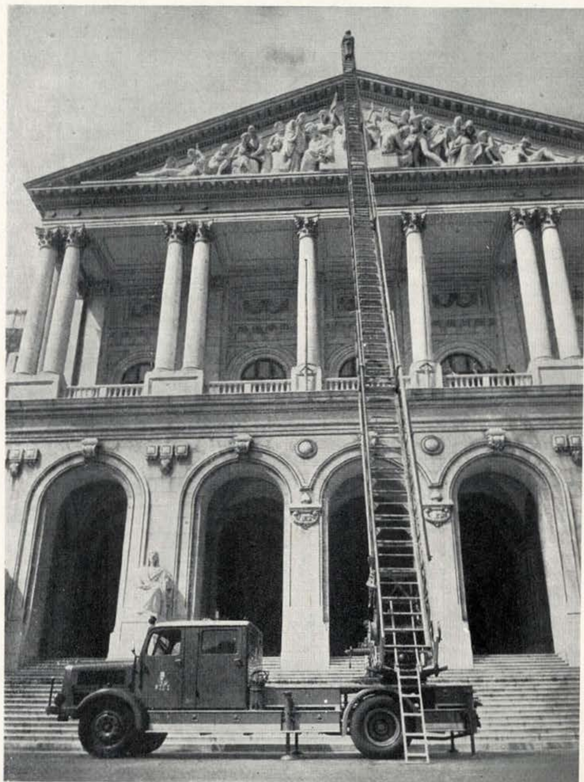
Serviço de Incêndios — Escada mecânica Metz, de 30 + 2 metros
