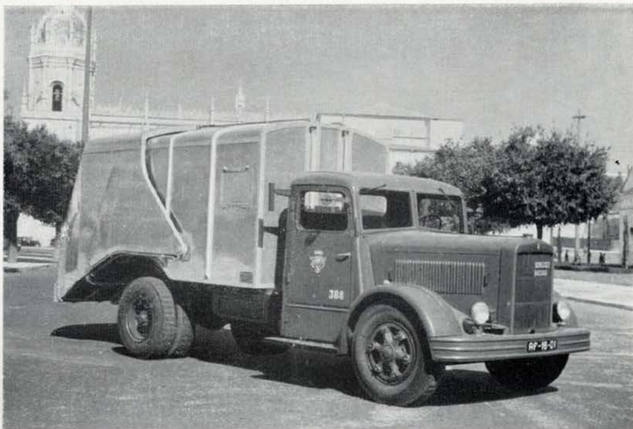
Remoção de lixo — Caminheta Berliet — Caixa sistema Ochsner , em material anti-corodal, equipada com adufas anti-poeiras — Capacidade 10 m 3
