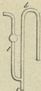
Fig. 30 — Modelo de syphão para liquidos corrosivos.
