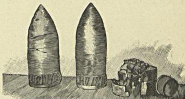
Sobre a placa d'aço      Sobre a placa Compound      Sobre a placa d'aço e níquel
