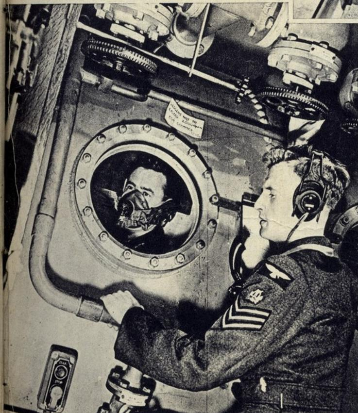
Dentro da câmara, o aviador vai sendo submetido às variações atmosféricas correspondentes a sucessivas altitudes, que se obtêm com auxílio de instrumentos especiais. O instrutor comunica telefonicamente com o interior
