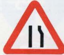
A10 b — Passagem estreita
