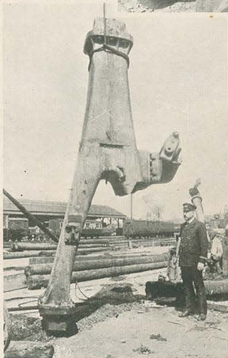
O suporte dos cilindros. Enorme peça que a explosão estilhaçou.
