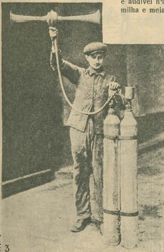
3. Sereia d'ar comprimido utilizada nos arsenaes militares.—1 Outro tipo de sereia d'ar comprimido usada nas proximidades das fabricas.
